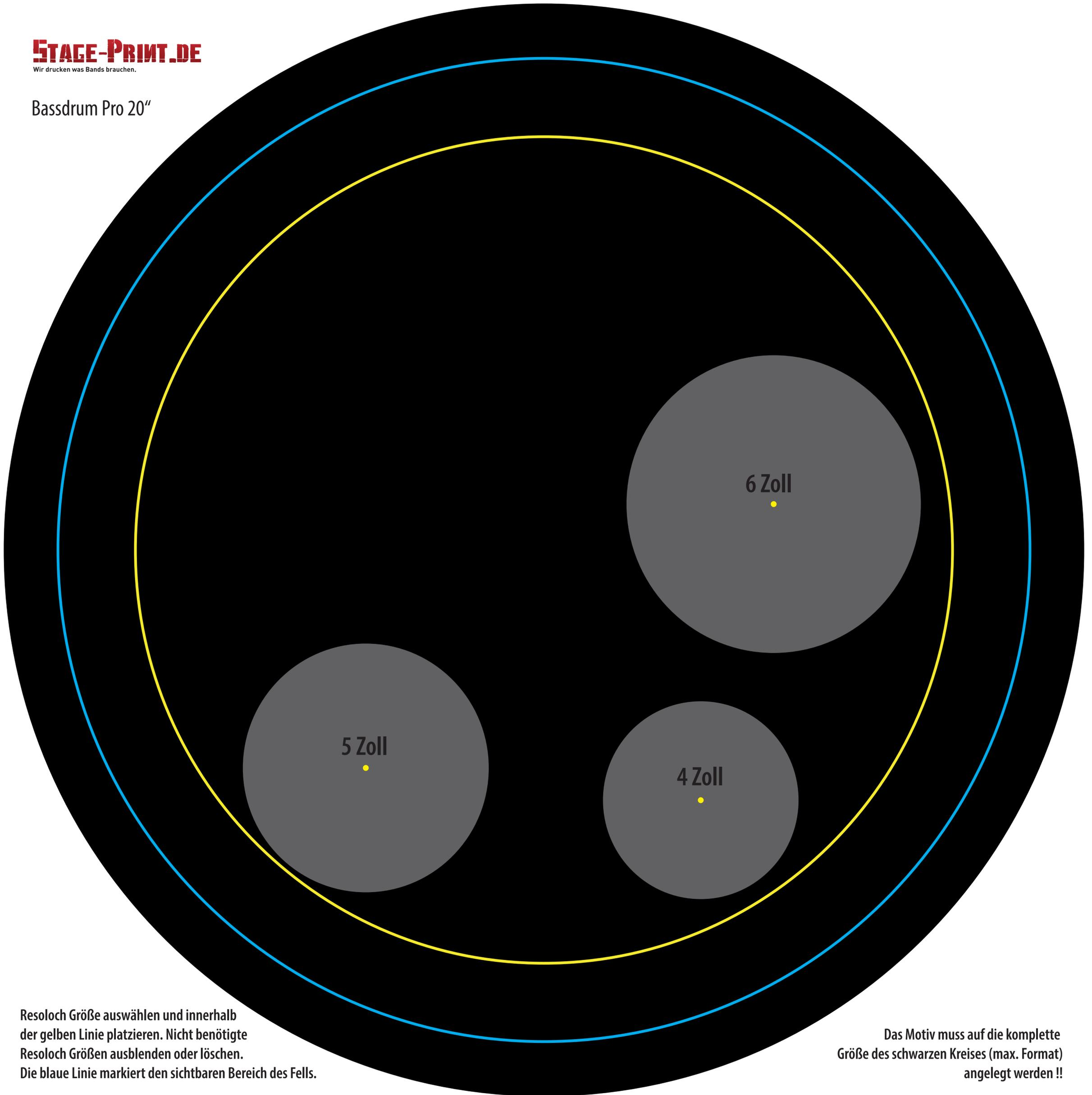
Resoloch Größe auswählen und innerhalb der gelben Linie platzieren. Nicht benötigte Resoloch Größen ausblenden oder löschen. Die blaue Linie markiert den sichtbaren Bereich des Fells.
